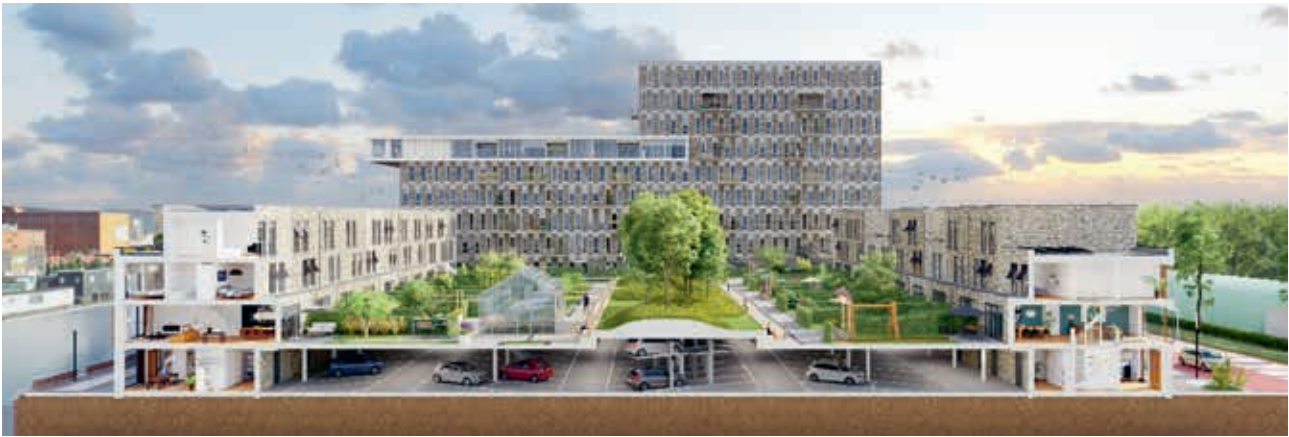
Doorsnede waarin parkeergarage zichtbaar is (toen nog met kolommen i.p.v. wanden in het verhoogde deel). (Illustratie: BoschSlabbers)
