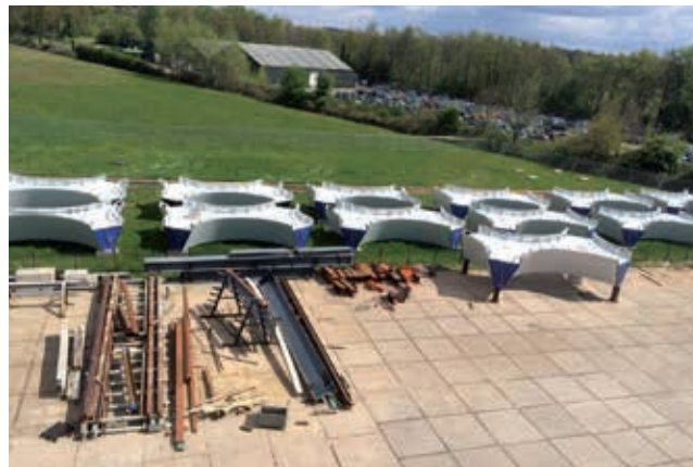
De segmenten zijn in de fabriek geprefabriceerd en tijdelijk opgeslagen alvorens op transport te gaan naar Utrecht (foto: Buiting Staalconstructie).
